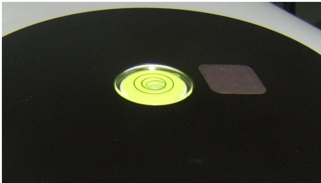
Rysunek 2. Poziomica w oprawie typu C-100-G - libella.
